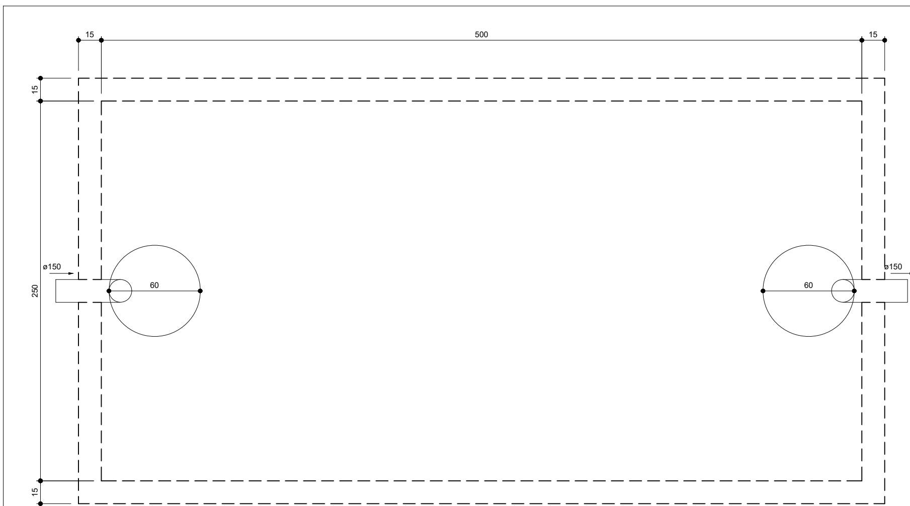
PLANTA BAIXA - TANQUE SÉPTICO 2 ESC. 1:25
